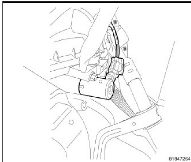
5. 直着将电磁阀拉出气缸盖。
